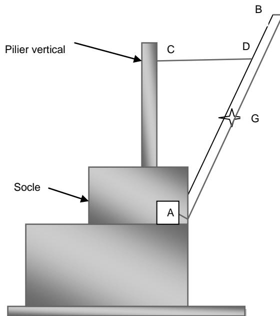
Cette grue est constituée d'un pilier vertical, d'une barre AB, de centre de gravité G, mobile autour d'un axe A perpendiculaire au plan de la figure et d'un câble CD.
