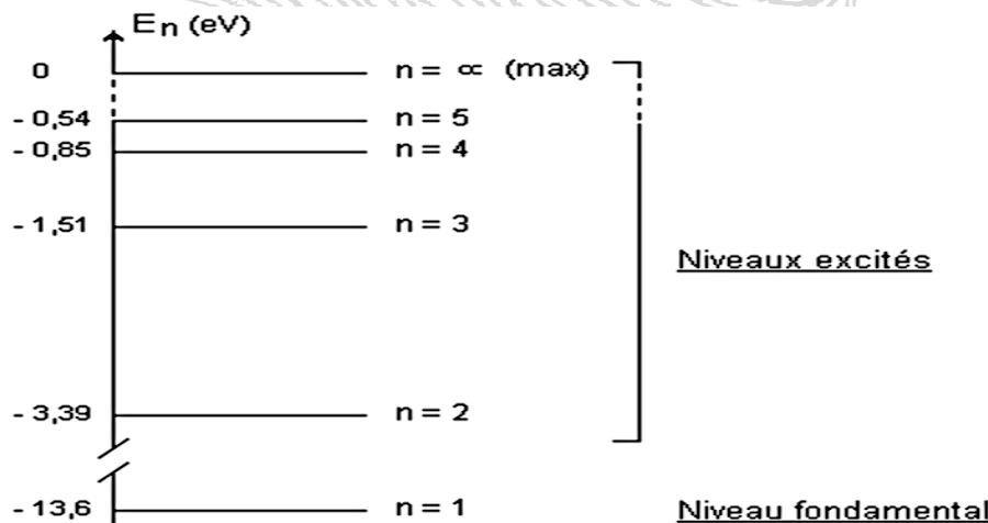
1.2. Le niveau d'énergie le plus bas  $E_1 = -13,6 \text{ eV}$ , il est obtenu pour  $n = 1$ , correspond au niveau fondamental de l'atome d'hydrogène. C'est l'état le plus stable. (0,5 pt)
