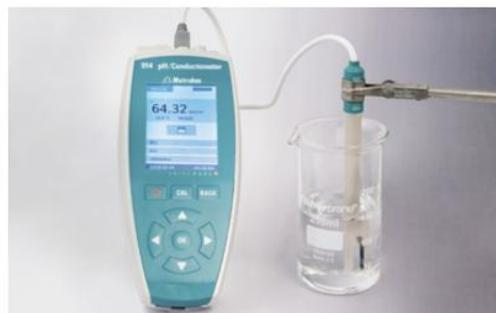
Un **conductimètre** permet de mesurer la conductivité d'une solution.
