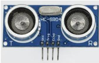
Ce module permet de mesurer la distance qui le sépare d'un obstacle.
