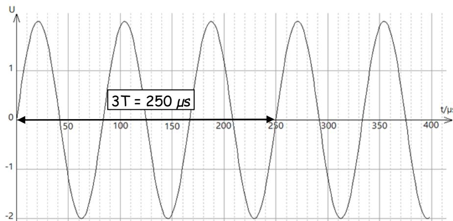
$$3T = 250 \mu\text{s} \quad \text{soit} \quad T = 83,3 \mu\text{s} = 8,33 \times 10^{-5} \text{ s} \quad f = \frac{1}{T} \quad \text{soit} \quad f = \frac{1}{8,33 \times 10^{-5}} = 12,0 \text{ kHz}$$
