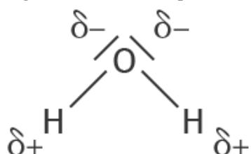
Comme la molécule d'eau est coudée, les polarisations de ces deux liaisons ne se compensent pas : la molécule d'eau est polaire.
