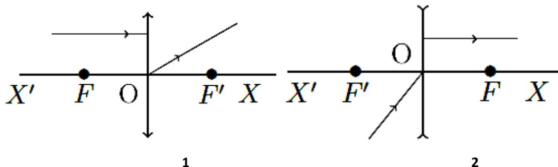
**3.2.** Reproduis les schémas numérotés 1,2 puis complète-les en traçant les rayons lumineux incidents ou émergents par rapport à une lentille convergente ou à une lentille divergente d'axe principal  $X'X$ . Les points  $F$  et  $F'$  désignent les foyers de ces lentilles. (03 pts)
