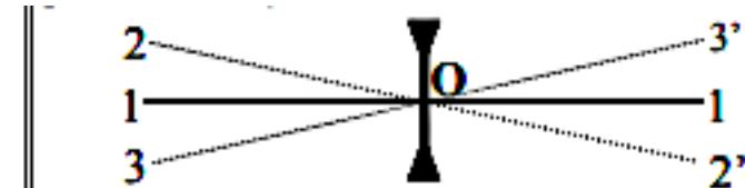
3.2. Les axes optiques : On appelle axe optique d'une lentille la trajectoire du rayon lumineux passant par son centre optique.
