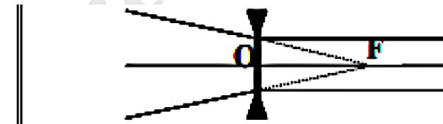
3.3.2. Le foyer - image  $F'$  : C'est l'image, par la lentille, d'un objet situé à l'infini.
