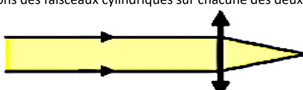
La lentille à bords minces transforme le faisceau cylindrique en faisceau convergent : c'est une **lentille convergente**
