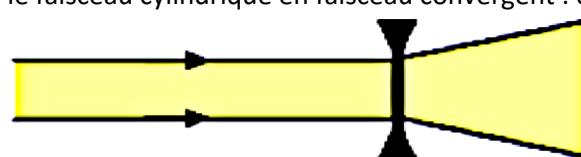
La lentille à bords épais transforme le faisceau cylindrique en faisceau divergent : c'est une **lentille divergente**.
