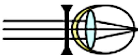
8.2.2. **L'hypermétropie** : **Le mal** : L'œil hypermétrope n'est pas assez convergent ; son cristallin a une distance focale longue : l'image se forme derrière la rétine, elle est floue.
