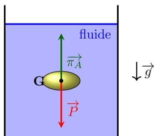
Exercée par un fluide sur le système plongé dans le fluide :
