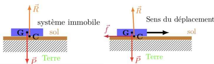
Exercée par le support sur lequel le système se déplace, ou par le fluide dans lequel il se déplace. C'est une action de contact :
