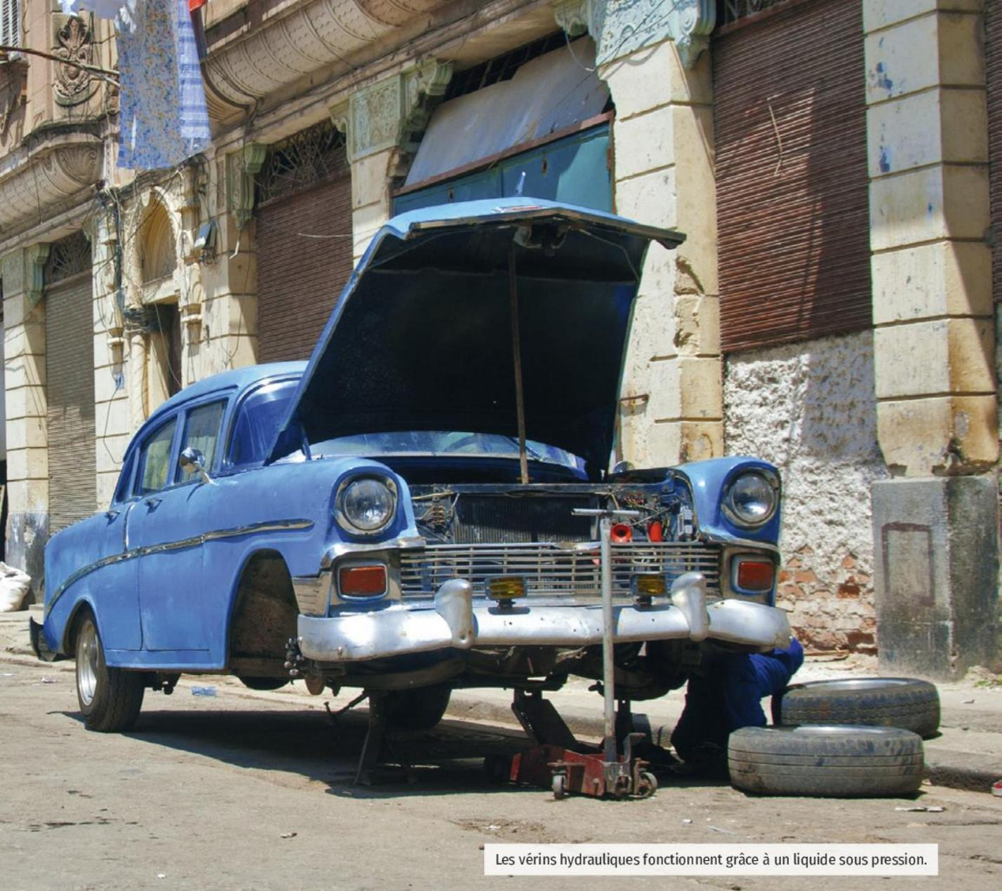
Les vérins hydrauliques fonctionnent grâce à un liquide sous pression.
