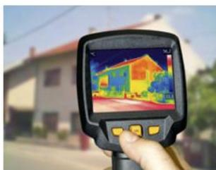
Utilisée dans de nombreux domaines, la thermographie permet de visualiser à distance la température d'un objet ou d'une personne. En médecine, l'imageur transforme le rayonnement infrarouge mesuré dans une bande spectrale comprise entre 2 et 5  $\mu\text{m}$  en un signal électrique
