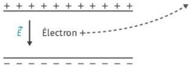
6. Comme l'électron est attiré vers la plaque positive, on peut en déduire que l'électron porte une charge électrique négative.
