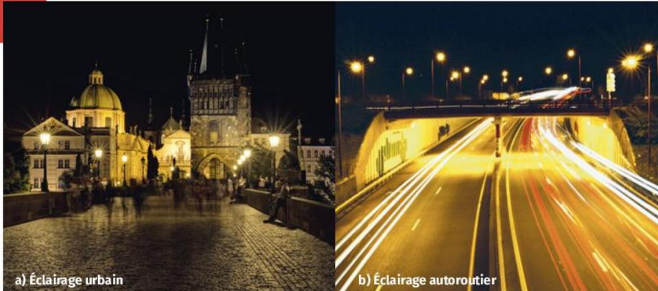
La lampe à vapeur de sodium a longtemps été utilisée pour l'éclairage routier. Elle émet une lumière de couleur jaune-orangé caractéristique.
